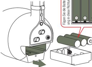
3 Bringen Sie die Abdeckung wie im Bild an, drücken Sie zum Schließen, und ziehen Sie die Schraube fest
