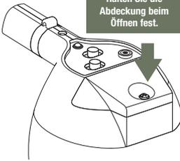
2 Entnehmen Sie die Batteriehalterung und setzen Sie die Batterien ein.
